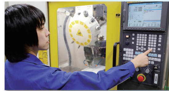
真空テーブル：立形マシニングセンタを活用して製作 真空テーブルで固定した樹脂素材を加工
