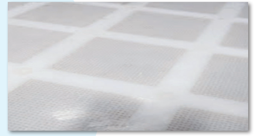
真空テーブル：立形マシニングセンタを活用して製作 表面の微細な穴から吸引し、表面を真空にするため
